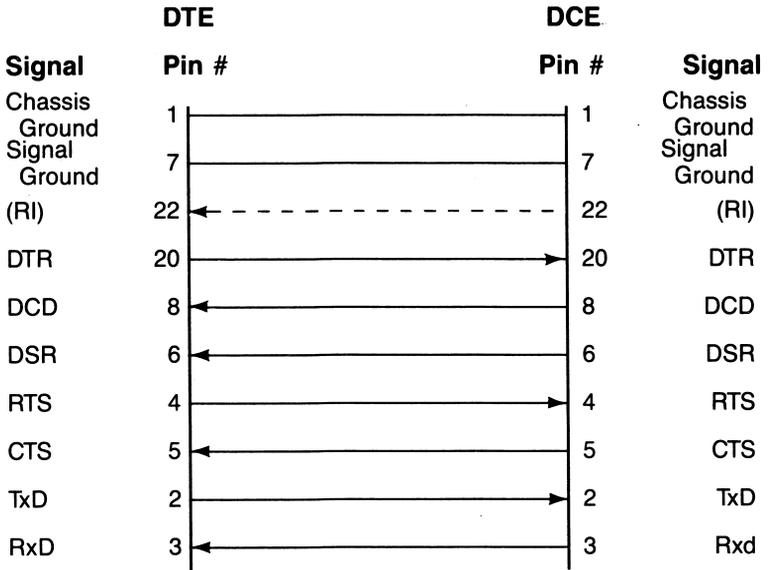
**Figure B-1. DTE-to-DCE Interface.**
