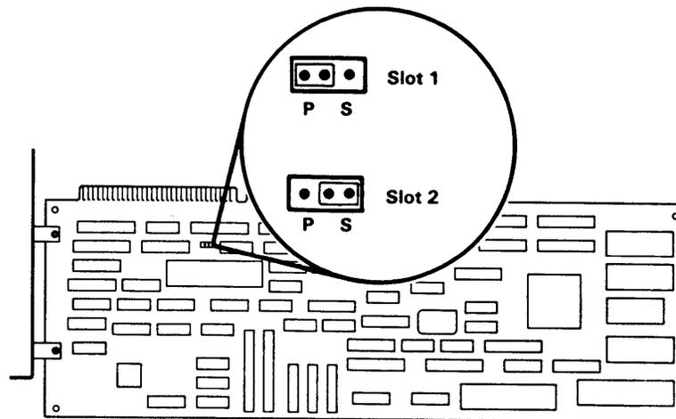
FIGURE 10. ADAPTER JUMPER
