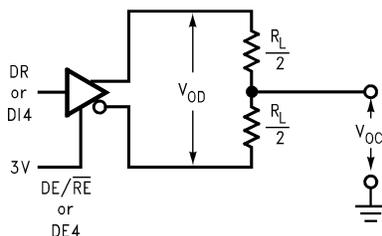
Figure 1. Driver  $V_{OD}$  and  $V_{OC}$ <sup>(3)</sup>
