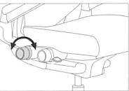
**Tensión de basculación** – Permite regular la resistencia del respaldo en función de su peso, tanto para sentarse en posición avanzada como para reclinarse. Gire la palanca hacia delante para aumentar la resistencia, hacia atrás para disminuirla.
