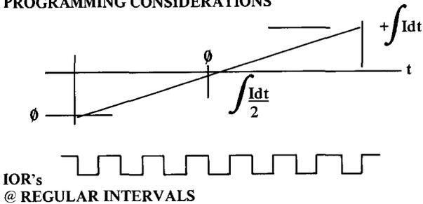
**ONCE TRIGGERED BY SOFTWARE THE INTEGRATOR CIRCUIT PRODUCES A PULSE THE DURATION OF WHICH IS DEPENDENT ON JOYSK POSITION.**
