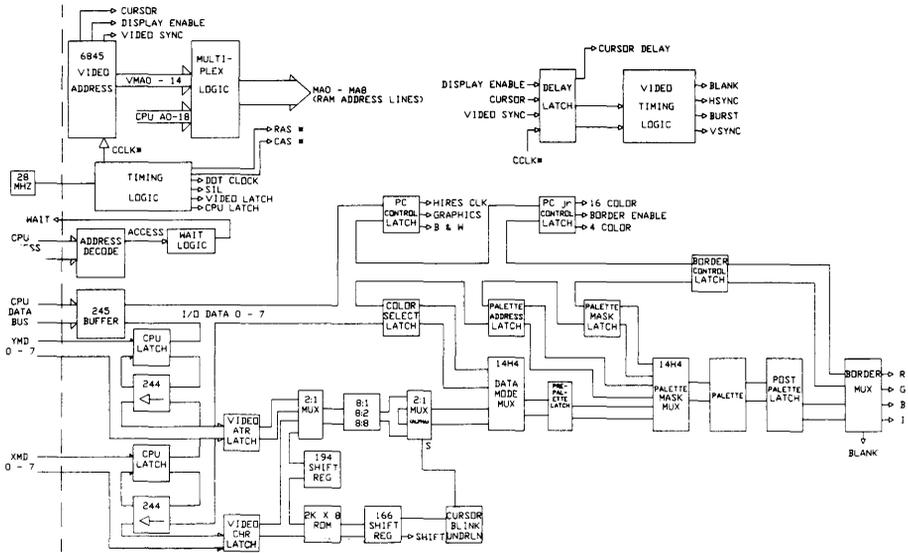
Figure 1. VIDEO CONTROLLER CHIP BLOCK DIAGRAM
