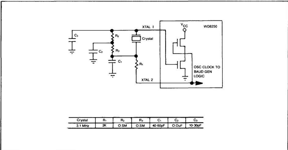
FIGURE 4. TYPICAL CRYSTAL OSCILLATOR NETWORK
