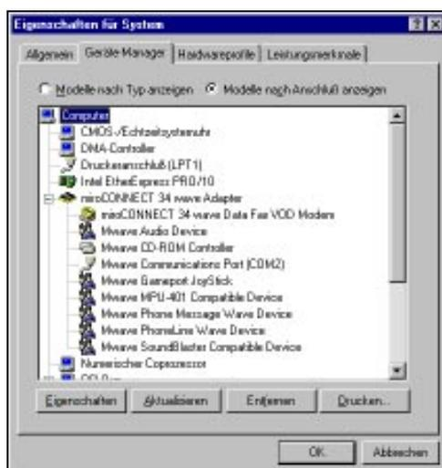
Bei PCs mit einem CD-ROM-Laufwerk, das an die 2. IDE-Schnittstelle des Motherboards angeschlossen ist, muß beispielsweise die IDE-Schnittstelle der miroCONNECT deaktiviert werden.
