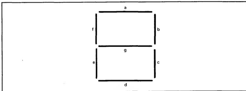
Figure 7-1. 7-Segment Arrangement
