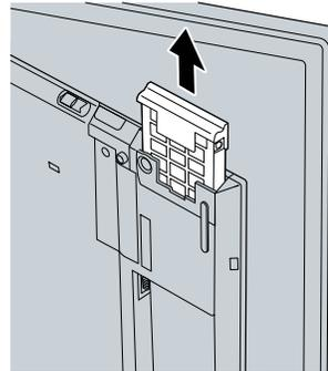
**5** カバーの両端の切り込み部分を同時に外側に押し、ハードディスク・ドライブからハードディスク・ドライブ・カバーを取り外します。
