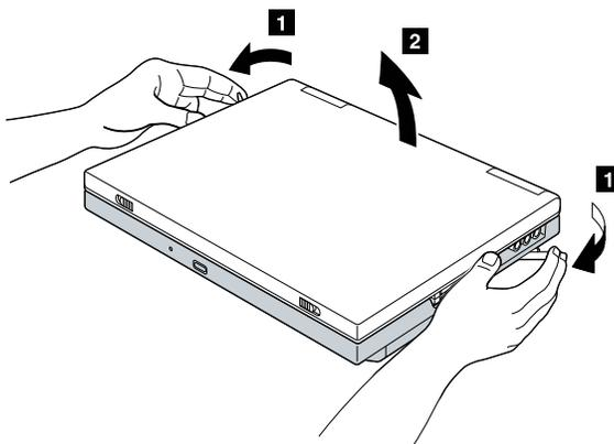
ThinkPad を稼働時あるいはサスペンド・モード時に取り外す場合は、タスクバーの右下にある「ウルトラベース接続状況」アイコンをクリックするか、前出の表の中で説明したように、ウルトラベースのイジェクト要求ボタンを押します。取り外す条件がそろったら、上の図のようにして ThinkPad を取り外します。
