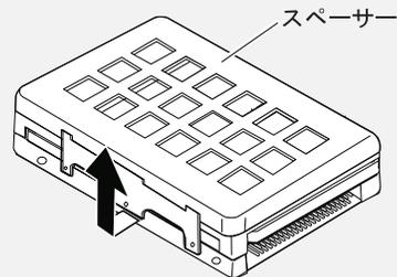
**6** カバーの両端の切り込み部分を同時に外側に押して、新しいハードディスク・ドライブをカバーに取り付けます。
