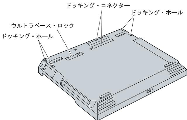
ウルトラベースには、ディスクレット・ドライブ / バッテリー・ベイおよびウルトラスリムベイという 2 つのベイがあります。ディスクレット・ドライブ / バッテリー・ベイには、次のどちらか 1 つを取り付けることができます。(同時装置はできません。)
