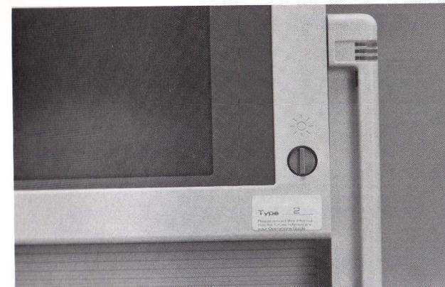
Figure 2-9. Fixed Disk Drive Type Label.
